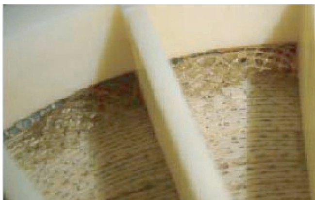
图 6-11 高压降导致进水隔栅被挤出图
