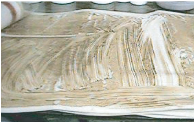
图 6-9 受悬浮物污染的膜元件端面图
