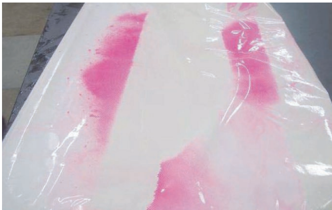
图 6-7 受到氧化的膜元件解剖图
