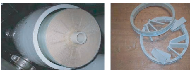
图 6-12 水锤导致膜的抗应力器损坏图
