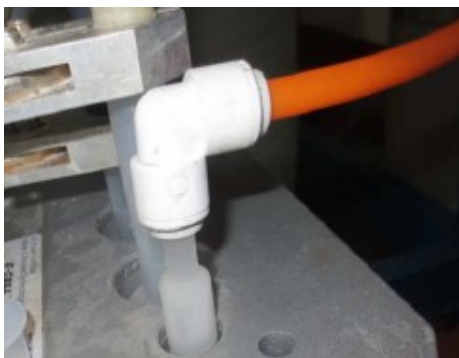
图 6-14 使用 3/8 尼龙管插入弯头，将插好 3/8 管路的弯头插入模块极水管口
