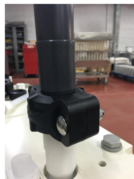
图 6-8 用螺栓螺母拧紧至 此连接完成
