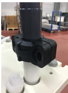
图 6-7 用大卡箍将连接处卡紧
