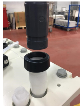
图 6-5 将淡水流程接头有凹 形槽的端部对准密封圈
