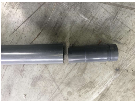
图 6-1 选用 DN40 管路；按照粘接 PVC
