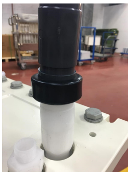
图 6-6 将淡水管接头卡紧在密封圈内
