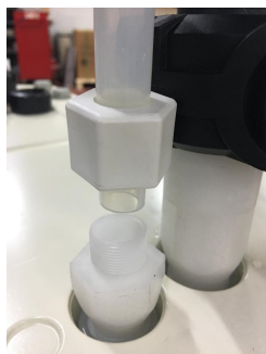
图 6-11 将浓水流接头端部
