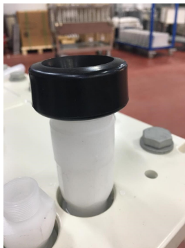
图 6-4 放置密封圈于淡水流程管上
