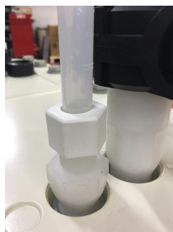
图 6-12 将浓水管接头
