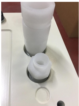
图 6-10 去除模块浓水接头堵头
